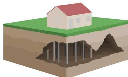
Schéma en coupe d'un projet nécessitant la mise en oeuvre de piliers en maçonnerie.
